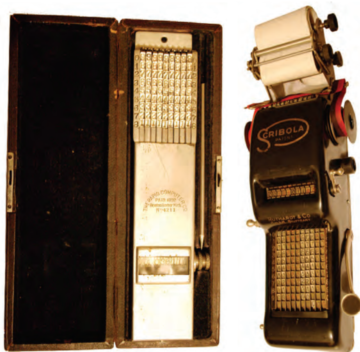
Rysunek 7. Kalkulatory: Rapid computer, Seidel&Neumann z drukarką
