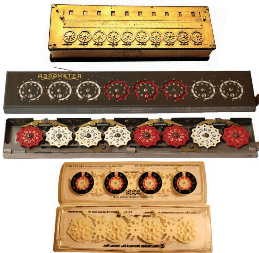
Rysunek 5. Pascalina ze zbiorów muzeum Salonu Aparatów Matematycznych i Astronomicznych (Zwinger) w Dreźnie; Addometer, późniejszy kalkulator zbudowany na idei Pascaliny – widok zewnętrzny i widok mechanizmu; Kalkulator See z widocznym mechanizmem dodawania i przenoszenia
