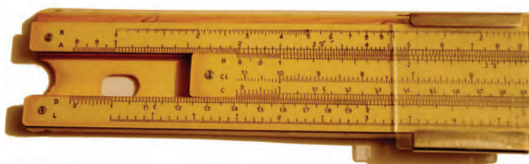
Rysunek 16. Dwie linijki logarytmiczne ustawione obok siebie, służą do obliczania iloczynu, w tym przypadku na skali A można odczytać wartości iloczynów przy mnożeniu przez 2,5 (1 na skali B jest ustawione pod 2,5 na skali A)
