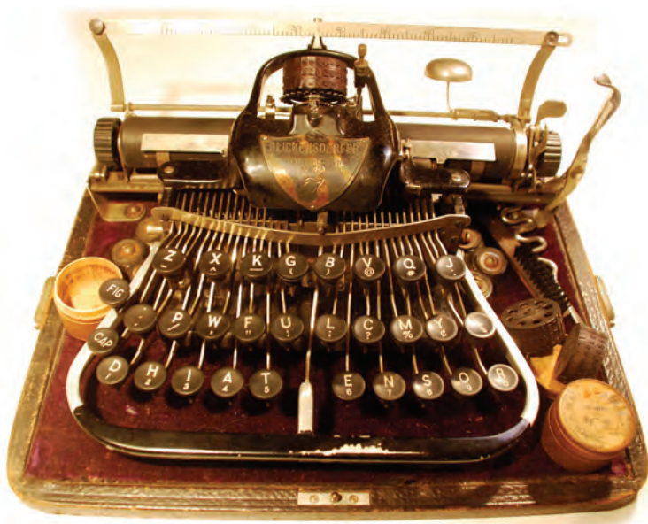
Rysunek 18. Maszyna do pisania Blickensderfer (USA, koniec XIX wieku), z wymiennymi główkami z czcionkami (w drewnianych pudełkach) oraz klawiaturą Morse’a
